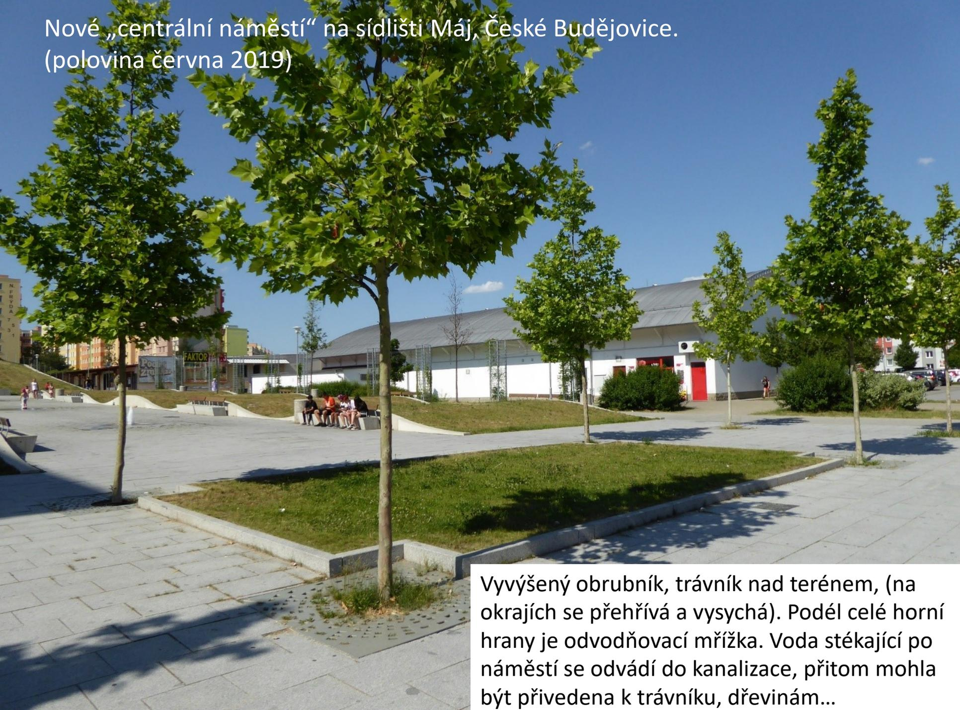
Vyvýšený obrubník, trávník nad terénem, (na okrajích se přehřívá a vysychá). Podél celé horní hrany je odvodňovací mřížka. Voda stékající po náměstí se odvádí do kanalizace, přitom mohla být přivedena k trávniku, dřevinám...
